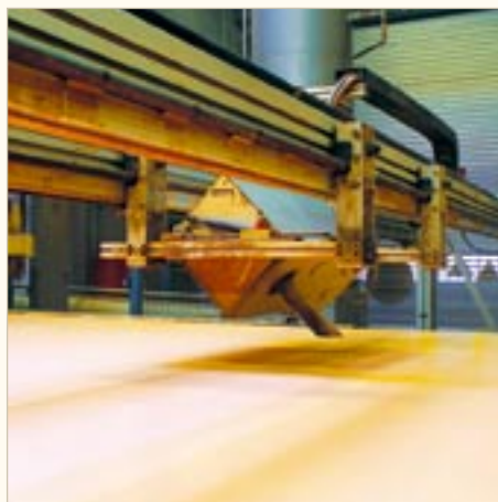
Установка измерения объемного профиля плотности в режиме on-line StenOgraph
